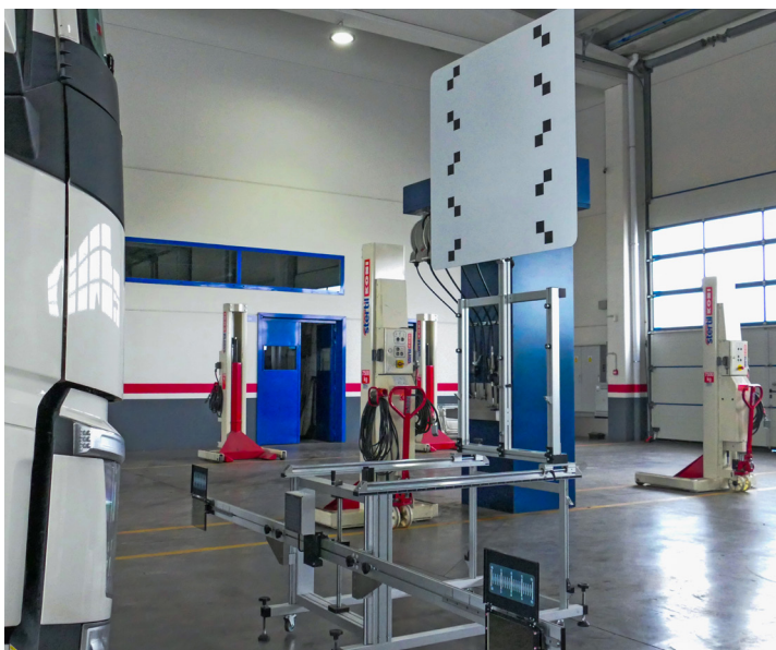
Image à titre d'information générale avec panneau de calibrage pour Volvo FH V4
