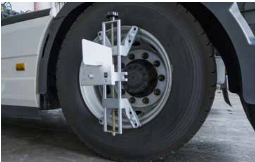
Útiles de acoplamiento de centrado para las ruedas
