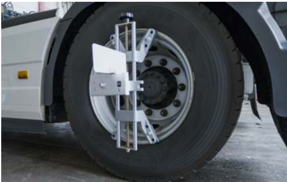
Utensili di accoppiamento per il centraggio delle ruote
