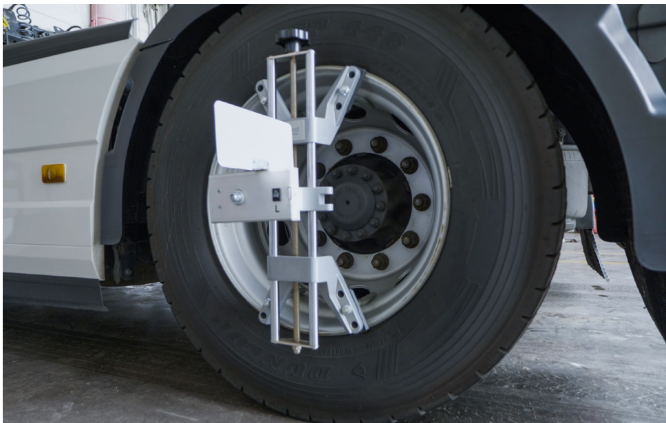
Outils d'accouplement de centrage pour les roues
