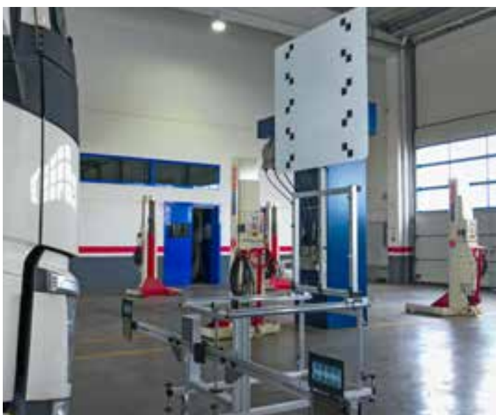
Imagen de carácter general a título informativo con panel de calibración para Volvo FH V4
