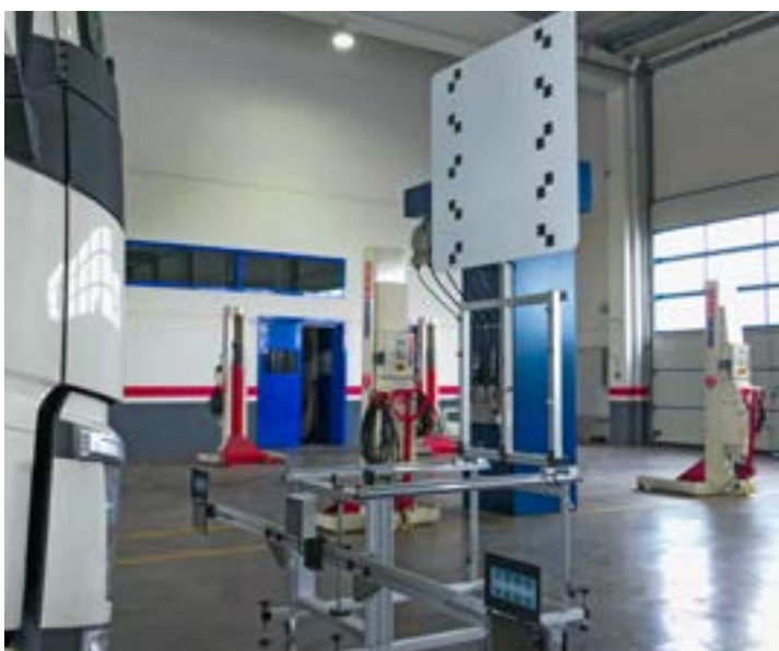
Immagine informativa generale con pannello di calibrazione per Volvo FH V4
