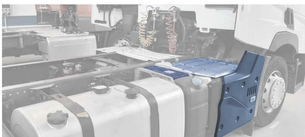
Montieren Sie für ein bequemeres Arbeiten auch die Stütze des Seitenblechs ab.
