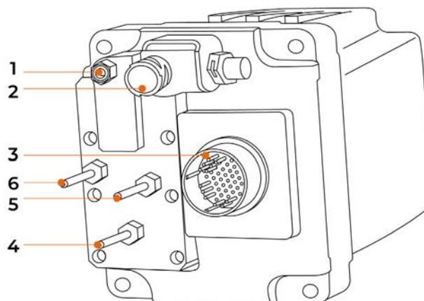
c. Collegare gli adattatori “4” (4a o 4b a seconda dei casi) e “5” nell’entrata dell’aria compressa del modulo di AdBlue/DEF (1) e nell’uscita dell’aria compressa del veicolo. In seguito, accoppiare un tubo (“1” e “3”) a ogni adattatore, ma non collegarli al serbatoio “2a”.
