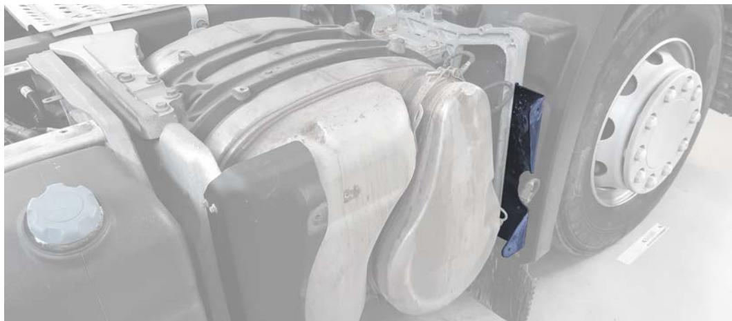
**c.** Halterung des AdBlue/DEF-Injektors demontieren und Injektor entnehmen.
