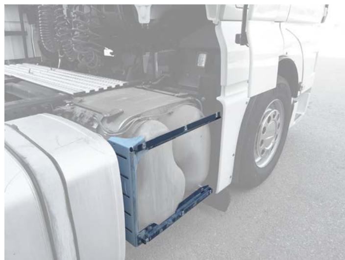
**d.** Démonter la fixation de l'injecteur d'AdBlue/DEF et extraire l'injecteur.
