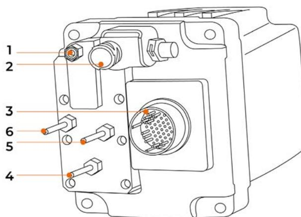
**c.** Подключите адаптеры “4” (4a или 4b в зависимости от ситуации) и “5” к впускному разъёму сжатого воздуха модуля AdBlue/DEF (1) и к выпускному разъёму сжатого воздуха транспортного средства. Затем присоедините шланг (“1” и “3”) к каждому адаптеру, но при этом, не подсоединяя их к ёмкости “2a”.
