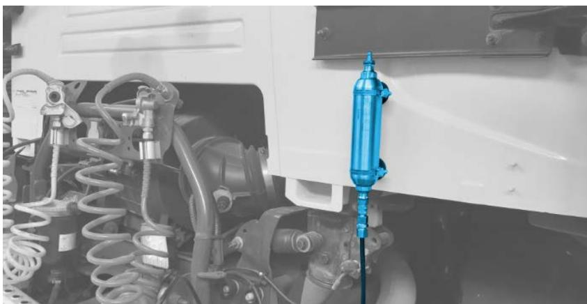
**f.** Заполните бак “2b” орячей дистиллированной водой (не более 60°C/140°F) из верхней части, используя наполнительную бутылку “6”.
