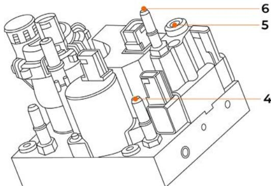
**b.** Подключите шланг “7” с быстроразъёмным соединением 3/8 к впускному патрубку AdBlue/DEF (3). (3).
