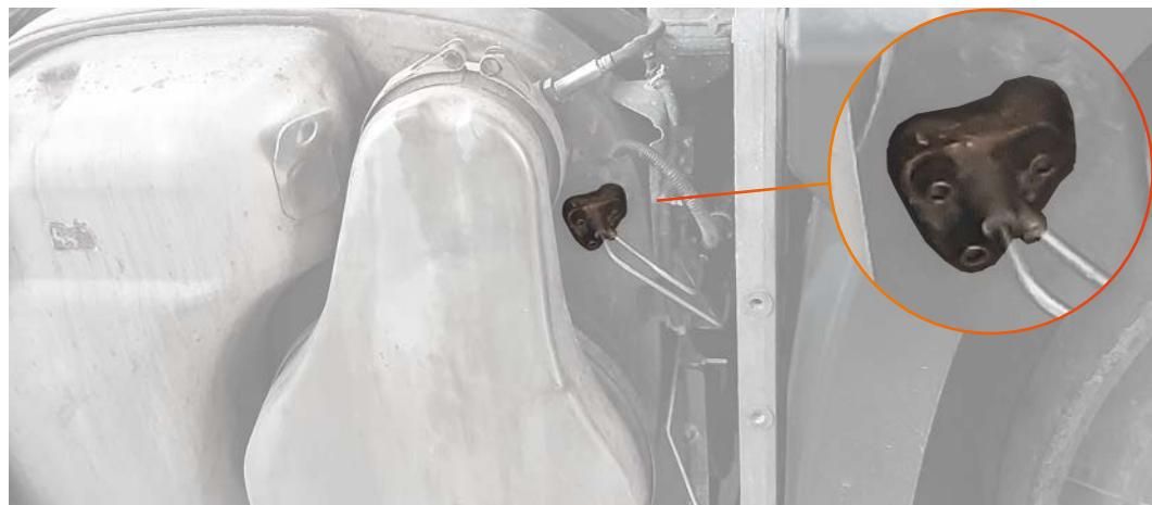
**d.** Colocar un recipiente en la boquilla del inyector.
