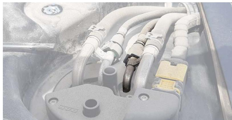
**e.** Collegare l'adattatore “9” o “10” e il tubo “3” nella connessione del tubo di ritorno verso il galleggiante. Inoltre, inserire l'estremità libera del tubo “3” in un recipiente..
