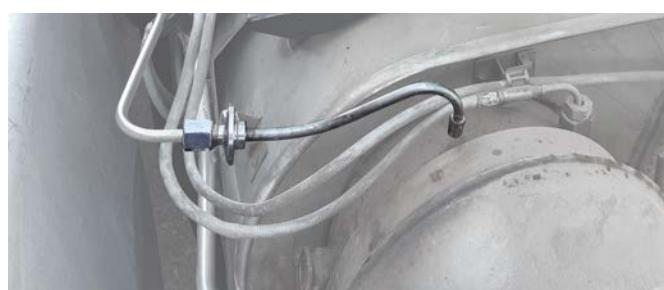
**Note:** pro zjednodušení během dalších kroků, odmontujte upevnění Nox senzoru.
