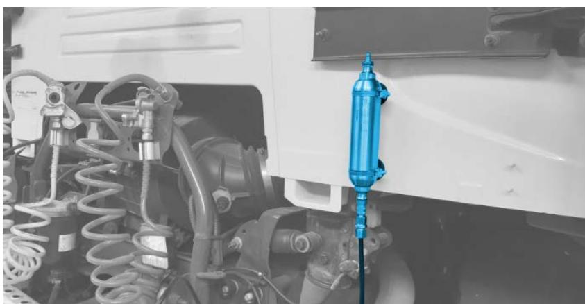
**f.** Encha o depósito **“2b”** com água destilada quente (60°C/140°F MAX.) pela parte superior, usando a garrafa de enchimento **“6”**.
