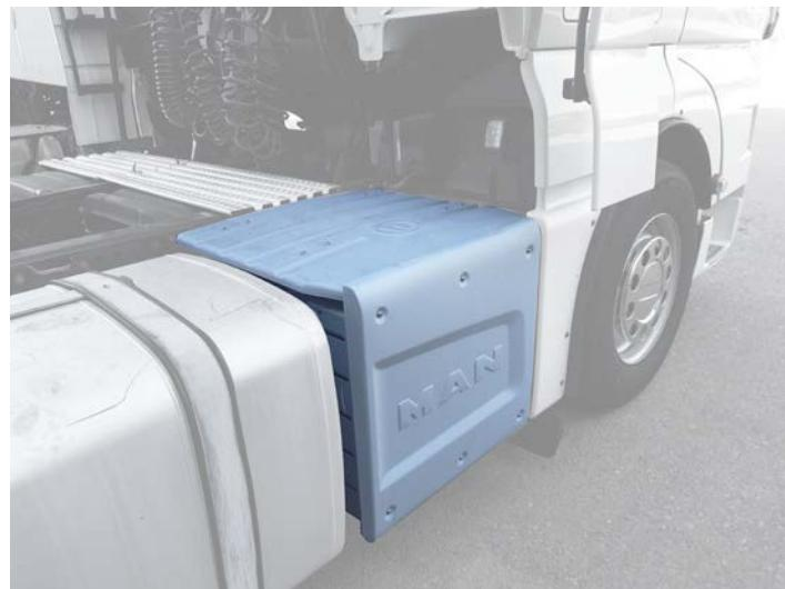
**c.** Демонтируйте кронштейны крепления пластин.
