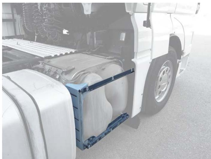
**d.** Odmontujte upevnění vstřikovače AdBlue/DEF a vytáhněte vstřikovač
