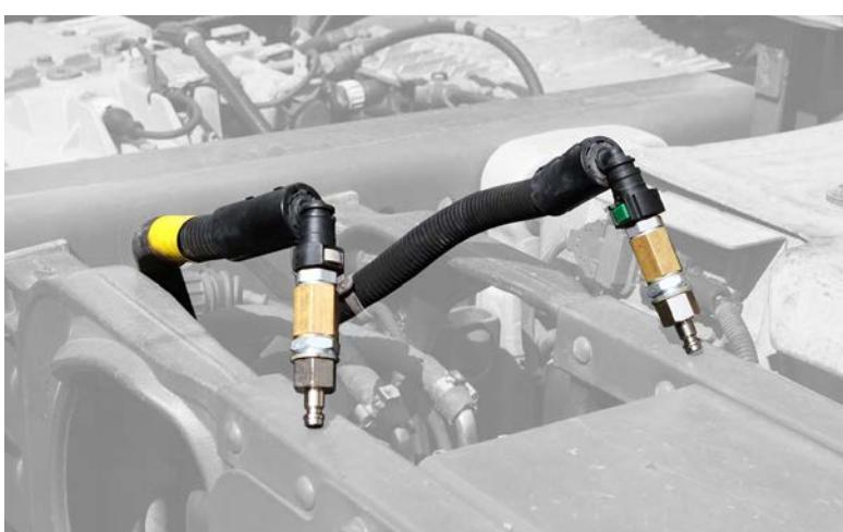
L'extrémité libre du tuyau connectée au tuyau menant au module d'AdBlue/DEF doit être connectée à la partie inférieure du réservoir “**2b**”, et celui du tuyau connecté au tuyau de retour, à un récipient destiné à recueillir l'eau qui circule et non à la renvoyer dans le réservoir d'AdBlue/DEF.
