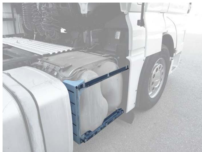
**d.** Desmontar o suporte do injetor de AdBlue/DEF e remover o injetor.
