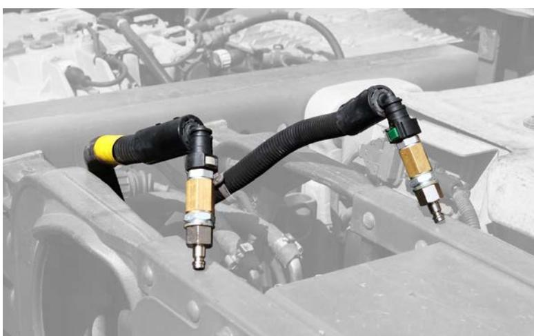
El extremo libre de la manguera conectada en la tubería que iba hacia el módulo de AdBlue/DEF se debe conectar a la parte inferior del depósito “**2b**”, y el de la manguera conectada a la tubería de retorno, a un recipiente para recoger el agua que circule y no devolverla al depósito de AdBlue/DEF.
