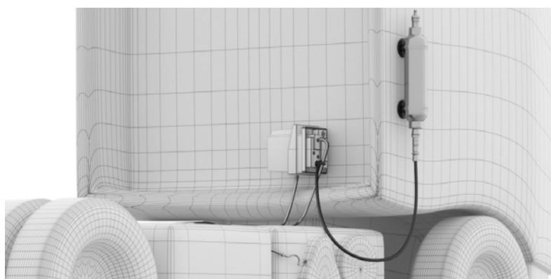
**f.** Vul tank “**2a**” met 250 ml heet gedestilleerd water (MAX. 60 °C / 140 °F) van bovenaf.
