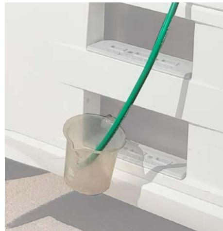
**f.** Выполнить действие по очистке модуля AdBlue/DEF с помощью диагностического оборудования.
