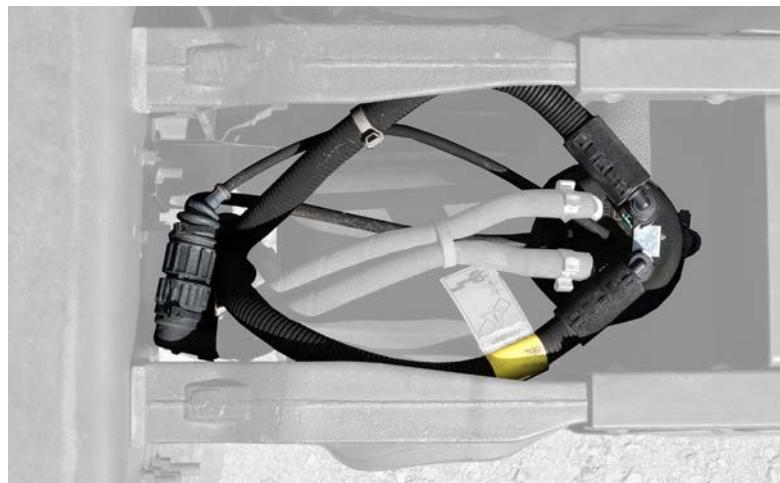
c. Localizar o injetor de AdBlue/DEF e desmontar a fixação para poder colocar um recipiente no bocal.
