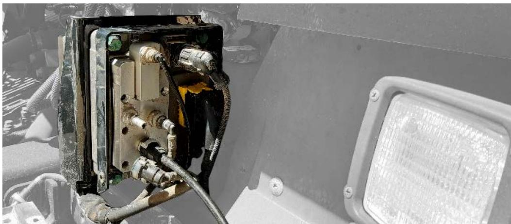
**e.** Connecter le tuyau au réservoir **“2a”**.
