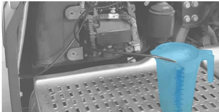
**e.** Conectar el otro extremo de la manguera “7” al enchufe rápido de la parte inferior del depósito **“2b”**.
