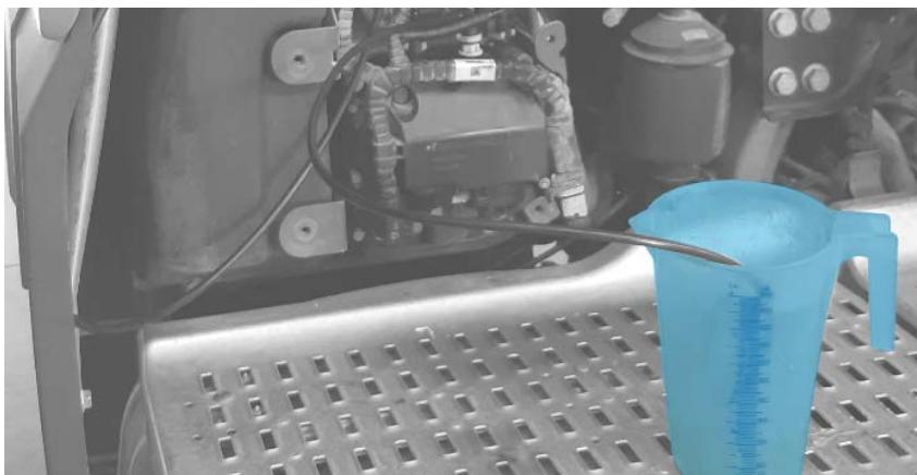
**e.** Csatlakoztassa a „**7**” tömlő másik végét gyorscsatlakozással a „**2b**” tartály aljához.
