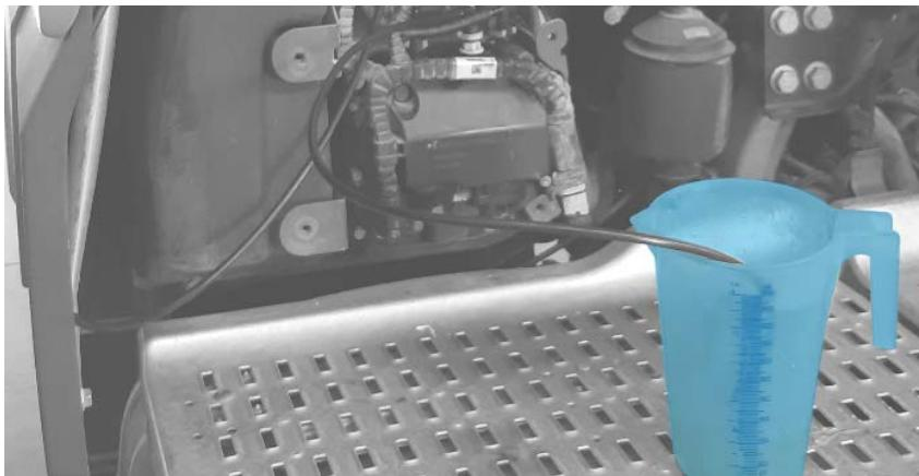
e. Schliessen Sie nun das andere Ende von Schlauch **“7”** an die Schnellkupplung am Unterteil von Behälter **“2b”** an.
