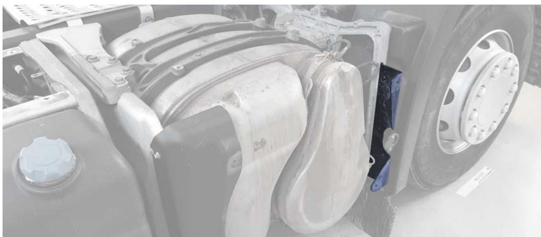
**c.** Demonteer de AdBlue/DEF-injectorbevestiging en verwijder de injector.
