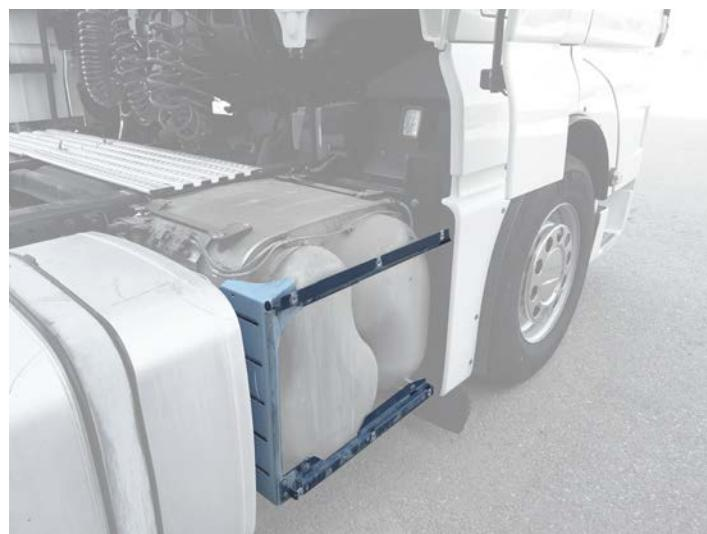
**d.** Демонтируйте крепление инжектора AdBlue/DEF и снимите инжектор.
