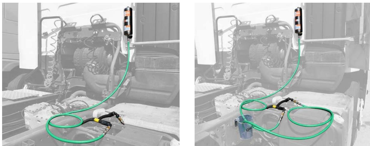
**c.** Naplňte nádrž **“2b”** horkou destilovanou vodou (max. 60 °C/140 °F) z horní části pomocí plnicí láhve **“6”**.
