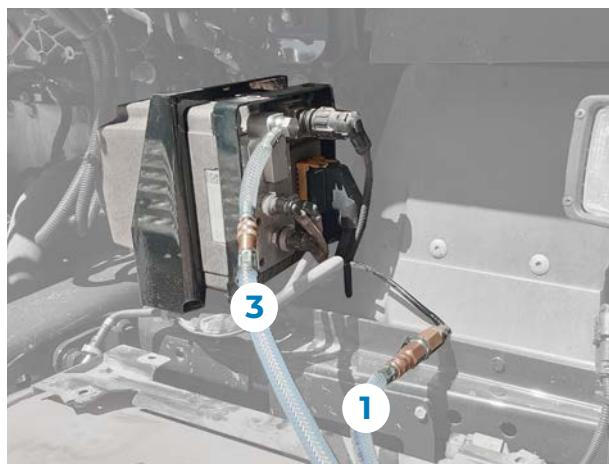
**d.** Vul tank **“2a”** met 250 ml heet gedestilleerd water (MAX. 60°C/140°F) vanaf het bovenste gedeelte, met behulp van de vulfles **“6”**. Bij de tweede versie worden de reservoires **“2a”** en **“2b”** samengevoegd tot één component. Let op: bij sommige tests is het nodig om adapter **“11”** aan te sluiten.
