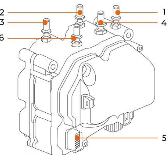
**c.** Csatlakoztassa a „**7**” tömlő másik végét 3/8"-as gyorscsatlakozóval az AdBlue/DEF bemeneti csatlakozóhoz **(6)**.
