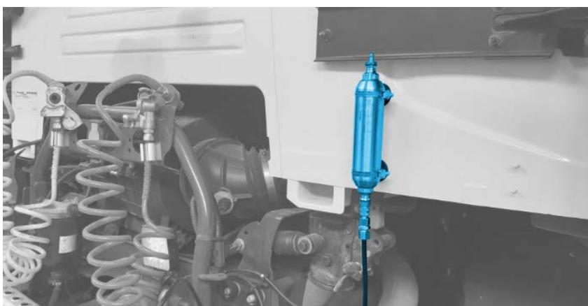
**f.** Remplir le réservoir **“2b”** par la partie supérieure avec de l’eau distillée chaude (MAX. 60 °C/140 °F), en utilisant la bouteille de remplissage **“6”**.
