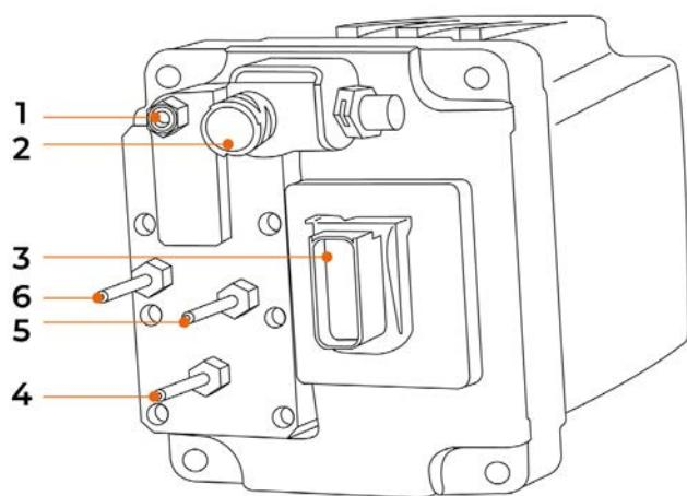
**c.** Подключите адаптеры **“4”** (**4a** или **4b** в зависимости от ситуации) и **“5”** к впускному разъёму сжатого воздуха модуля AdBlue/DEF **(1)** и к выпускному разъёму сжатого воздуха транспортного средства. Затем присоедините шланг **(“1” и “3”)** к каждому адаптеру, но при этом, не подсоединяя их к ёмкости **“2a”**.
