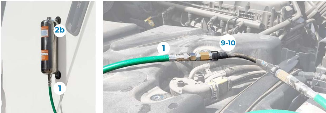
**c.** Заполнить бак “2b” горячей дистиллированной водой (не более 60°C/140°F) из верхней части, используя наполнительную бутылку “6”.
