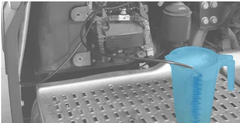
**e.** Collegare l’altra estremità del tubo “**7**” all’attacco rapido della parte inferiore del serbatoio **“2b”**.
