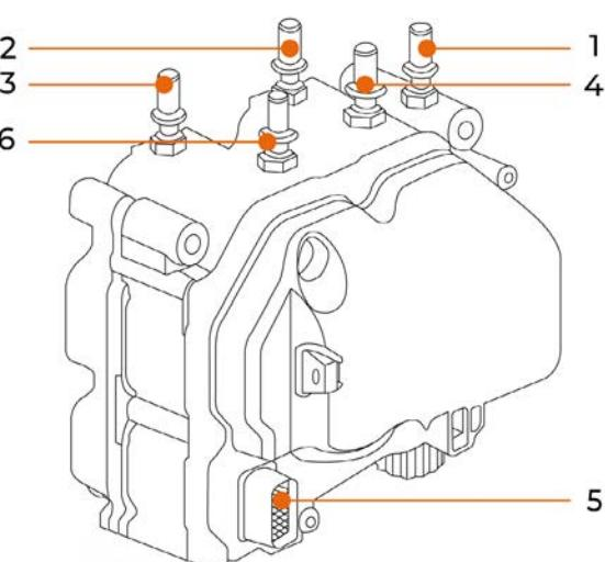
**c.** Connecter le tuyau “**7**” avec raccord rapide de 3/8” à la tige d’entrée d’AdBlue/DEF **(6)**.
