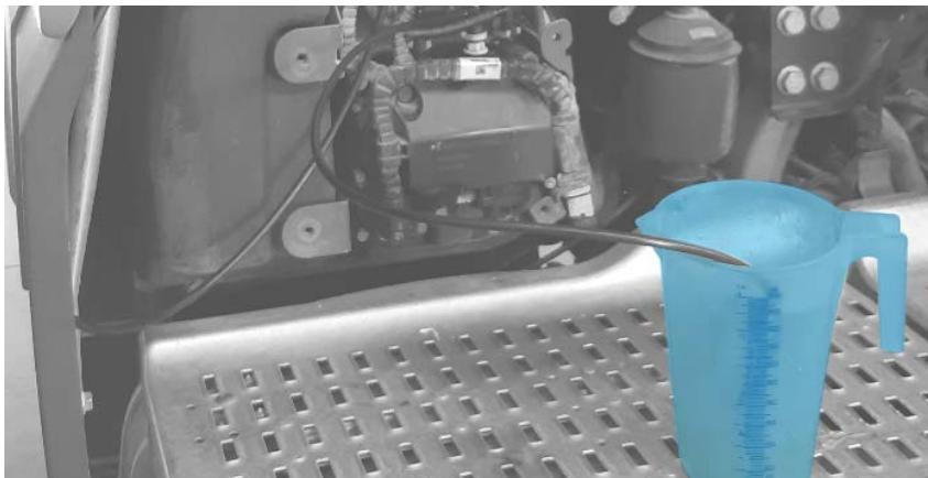
**e.** Conecte a outra extremidade da mangueira “7” ao conector rápido da parte inferior do depósito **“2b”**.
