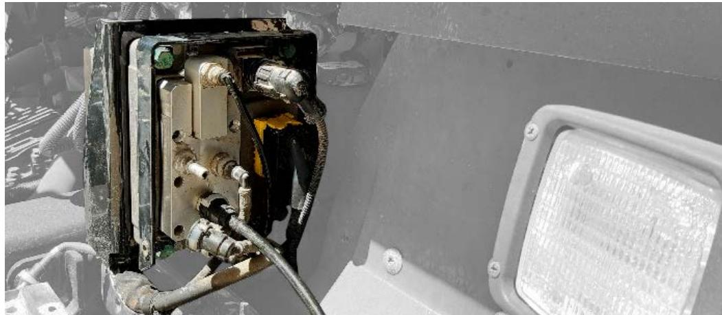
**e.** Schlauchleitung an den Tank **"2a"** anschliessen.
