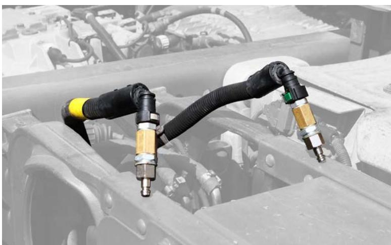
L'estremità libera del tubo collegata al tubo che va verso il modulo di AdBlue/DEF deve essere collegata alla parte inferiore del serbatoio **“2b”**, e quella del tubo collegata al tubo di ritorno a un recipiente per raccogliere l'acqua in circolo in modo che non torni al serbatoio di AdBlue/DEF.
