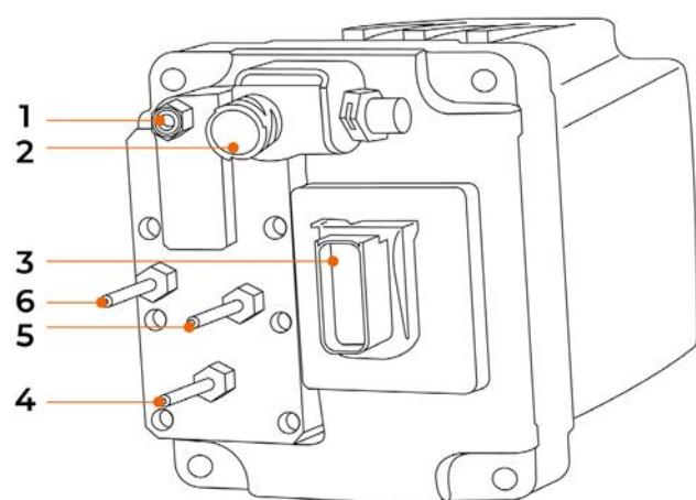
**c.** Adapter **“4”** (**4a** oder **4b**) je nach Sachlage) und **“5”** am Drucklufteingang des AdBlue/DEF Modul **(1)** und am Druckluftausgang des Fahrzeuges anschliessen. Danach an jeden Adapter einen Schlauch (**“1”** und **“3”**) ankoppeln, aber noch nicht an den Tank **“2a”** anschliessen.
