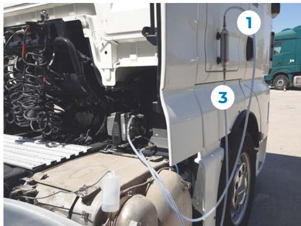
**f.** Запустите двигатель и поддерживайте его работу до тех пор, пока контур системы сжатого воздуха не будет заполнен.
