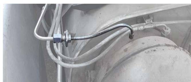
**Nota:** per una maggiore comodità durante le prove successive, smontare il fissaggio del sensore NOx.
