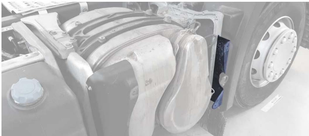
**c.** Desmontar o suporte do injetor de AdBlue/DEF e remover o injetor.
