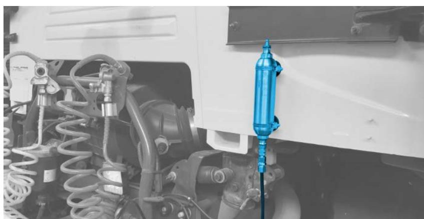
**f.** Llenar el depósito **“2b”** por la parte superior con agua destilada caliente (MÁX. 60 °C/140 °F), utilizando la botella de llenado **“6”**.
