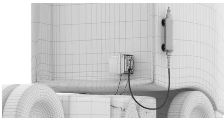
**f.** Llenar el depósito “**2a**” con 250 ml de agua destilada caliente (MÁX. 60 °C/140 °F) por la parte superior.
