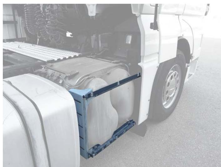
**d.** Halterung des AdBlue/DEF-Injektors demontieren und Injektor entnehmen.
