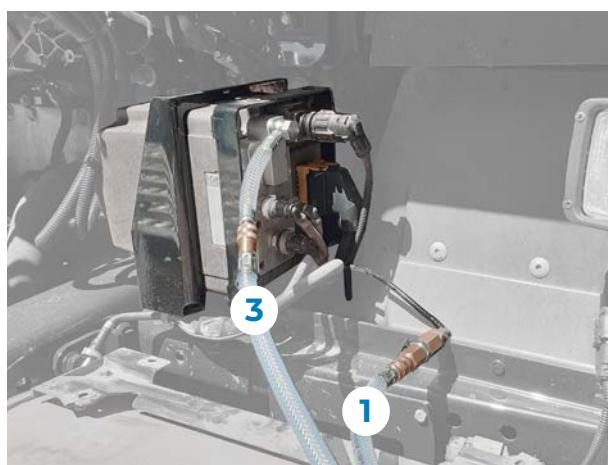
**d.** Encher o depósito **“2a”** or cima com 250 ml de água destilada quente (MÁX. 60 °C/140 °F), utilizando a garrafa de enchimento **“6”**. Na segunda versão, os depósitos **“2a”** e **“2b”** são unificados num único componente. Note-se que, em alguns testes, é necessário ligar o adaptador **“1”**.
