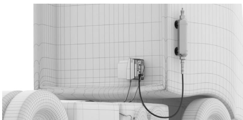
**f.** Remplir le réservoir “**2a**” avec 250 ml d'eau distillée chaude (MAX. 60 °C/140 °F), par la partie supérieure.
