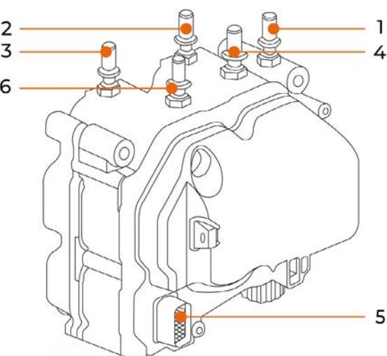
**c.** Подсоедините шланг “7” с быстроразъемным соединением 3/8” к впускному разъёму AdBlue/DEF (6).
