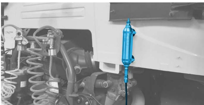
**f.** Riempire il serbatoio **“2b”** dalla parte superiore con acqua distillata calda (MAX. 60 °C/140 °F) utilizzando la bottiglia per il rabbocco **“6”**.
