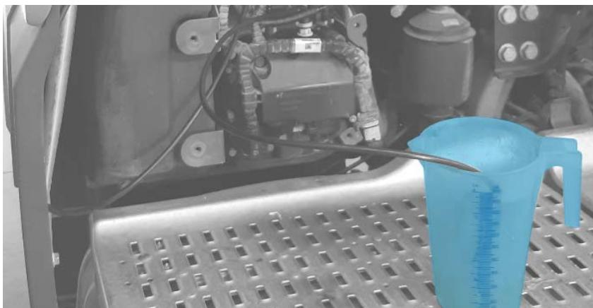
**e.** Connecter l’autre extrémité du tuyau **“7”** au raccord rapide de la partie inférieure du réservoir **“2b”**.
