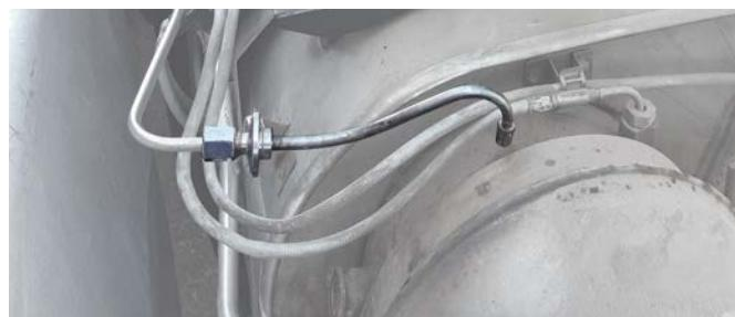
**e.** Desmontar as proteções do módulo de AdBlue/DEF.
