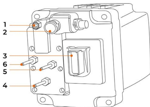
**c.** Conecte os adaptadores **“4”** (**4a** ou **4b** conforme apropriado) e **“5”** na entrada de ar comprimido do módulo de AdBlue/DEF **(1)** e na saída de ar comprimido do veículo. Em seguida, conecte uma mangueira (**“1”** e **“3”**) em cada adaptador, mas ainda sem conectá-las ao tanque **“2”**.
