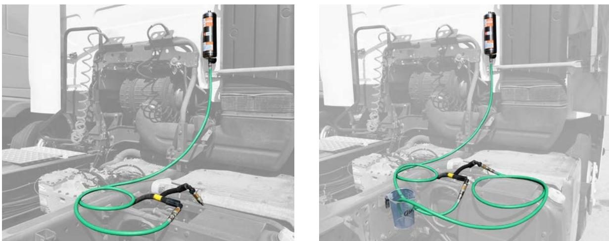
**c.** Llenar el depósito “**2b**” por la parte superior con agua destilada caliente (MÁX. 60 °C/140 °F), utilizando la botella de llenado “**6**”.
