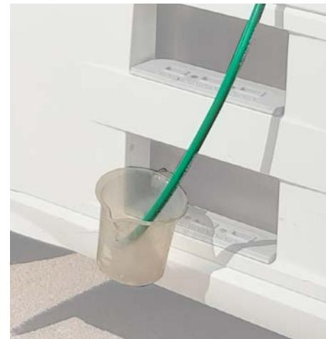
**f.** Con lo strumento di diagnosi, eseguire l'azione di pulizia del modulo di AdBlue/DEF.
