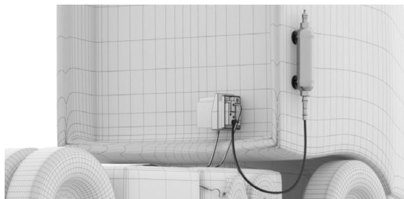
**f.** Tank "2a" von oben mit 250 ml warmem, destilliertem Wasser (MÁX. 60 °C/140 °F) füllen.
