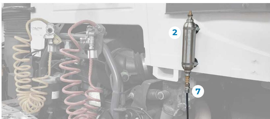
**d.** Заполните резервуар “2а” на 250 мл горячей дистиллированной водой (МАХ. 60°C/140°F) через верхнюю часть, используя заправочную ёмкость “6”. Во второй версии баки “2а” и “2б” объединены в один компонент. Обратите внимание, что для некоторых тестов необходимо подключение штуцера “11”.
