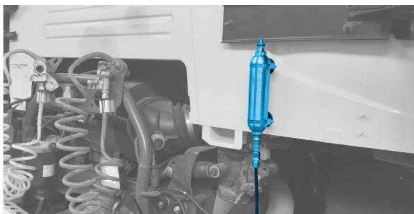
**f.** Pomocou plniacej fľaše **“6”** naplňte nádrž **“2b”** z horní strany horúcou destilovanou vodou (max. 60 °C/140 °F).
