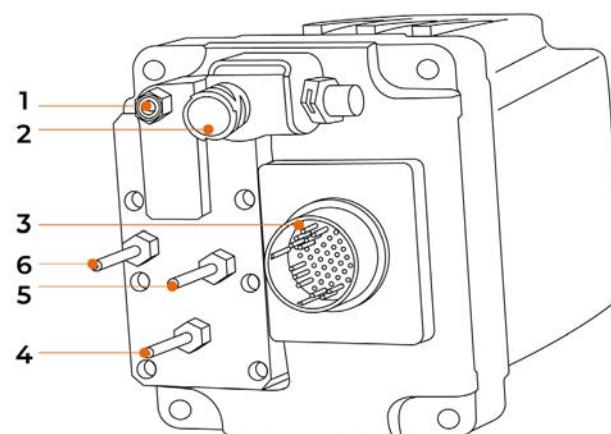
c. Verbind adapters "4" (4a of 4b als nodig) en "5" met de ingang van de perslucht van de AdBlue/DEF module (1) en de persluchttoevoer. Vervolgens, sluit de leidingen aan ("1" en "3") op de adapters zonder deze reeds op de tank aan te sluiten "2a".
