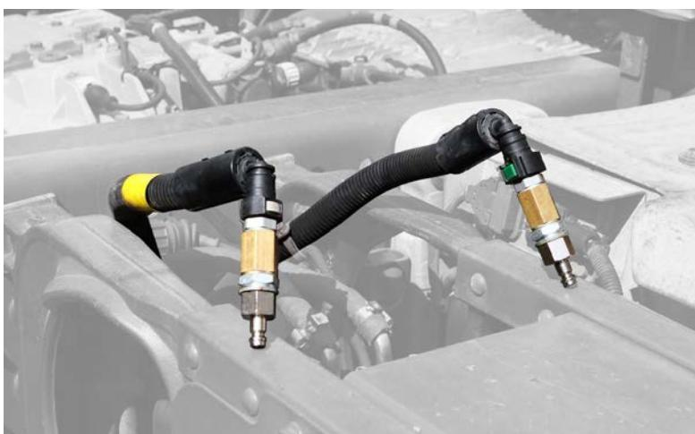
Het vrije uiteinde van de slang die is aangesloten op de leiding naar de AdBlue/DEF-module moet worden aangesloten op de bodem van tank “**2b**” en het uiteinde van de slang die is aangesloten op de retourleiding moet worden aangesloten op een reservoir om het circulerende water op te vangen en niet om het terug te voeren naar de AdBlue/DEF-tank.
