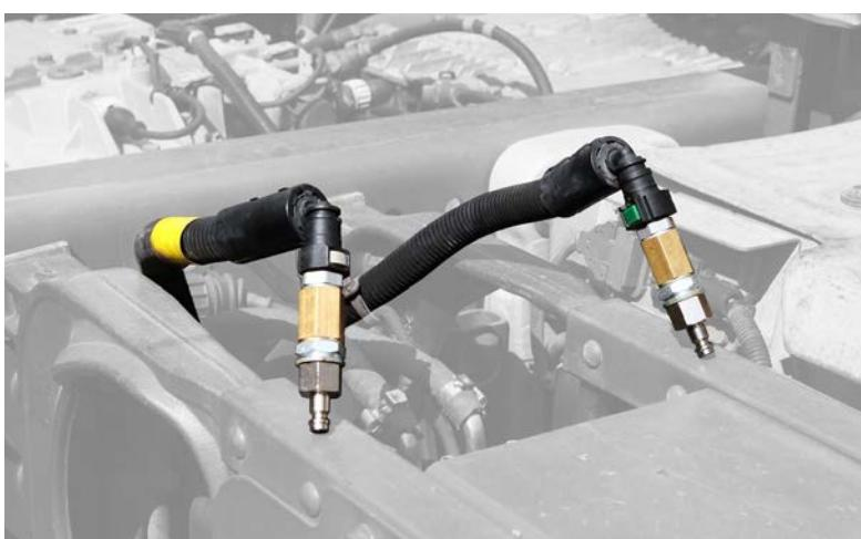
Das freie Ende des Schlauches, der mit der Leitung zum AdBlue/DEF-Modul verbunden ist, muss mit dem Anschluss **“2b”** an der Unterseite des Behälters verbunden werden, und das freie Ende des Schlauches, der mit der Rücklaufleitung verbunden ist, muss in einen Behälter gesteckt werden, der das zirkulierende Wasser auffängt und es nicht in den AdBlue/DEF-Behälter zurückleitet.
