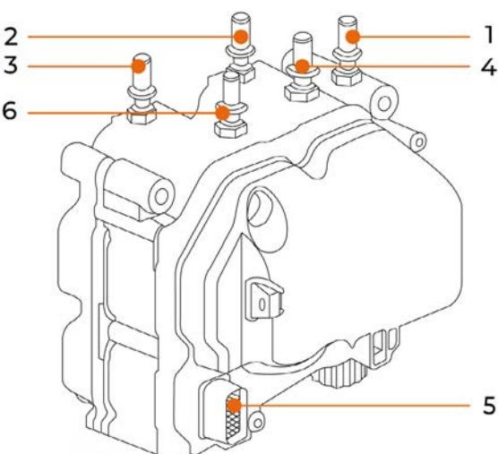
**c.** Conecte a mangueira “7” com engate rápido de 3/8” ao conector de entrada de AdBlue/DEF **(6)**.
