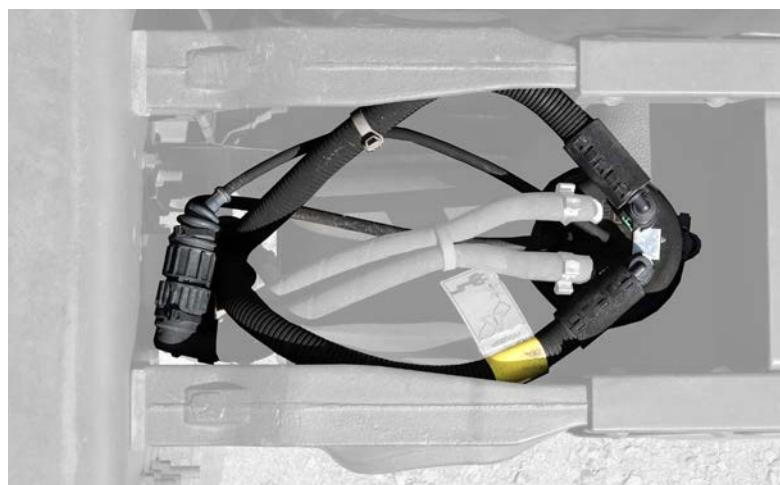
**c.** Die AdBlue/DEF-Einspritzdüse ausfindig machen und ihre Halterung entfernen, damit ein Behälter an der Düse angebracht werden kann.
