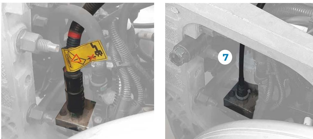
**c.** Подключите другой конец шланга “7” с быстроразъёмным соединением к верхней части резервуара “2а”.
