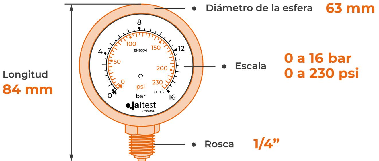
Manómetro indicado para instalaciones neumáticas. La glicerina amortigua los picos de presión, impactos mecánicos y vibraciones, además protege los componentes mecánicos del manómetro y permite una lectura precisa.
